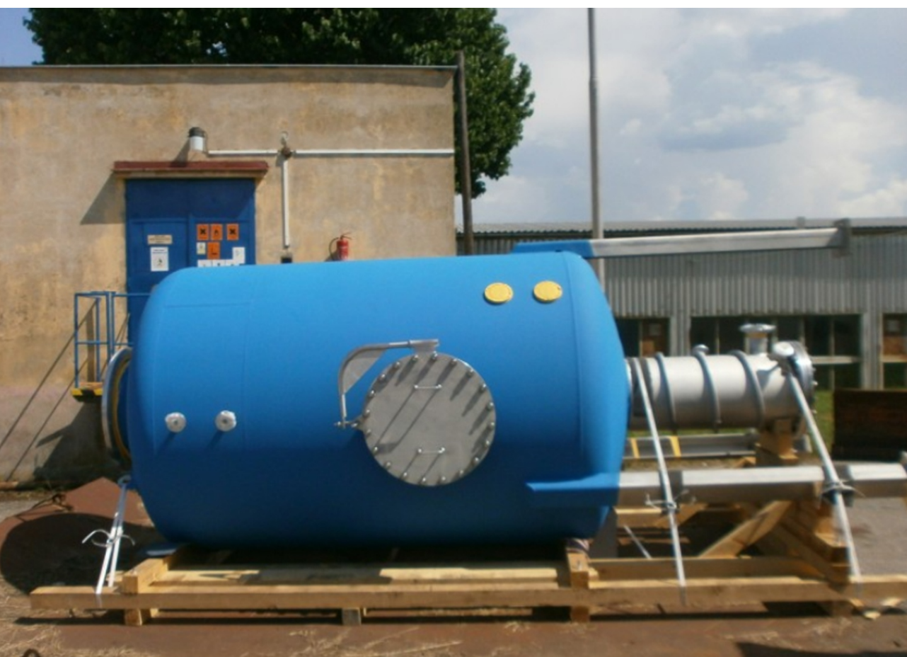
Zteplená nádrž na vodu, Zdroj: fotoarchiv Aditex, spol. s.r.o.
